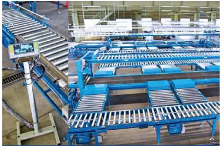
2 選別計量設備 等階級ごとに荷受用コンテナに選別し、計量後に荷造り部へ搬送。
