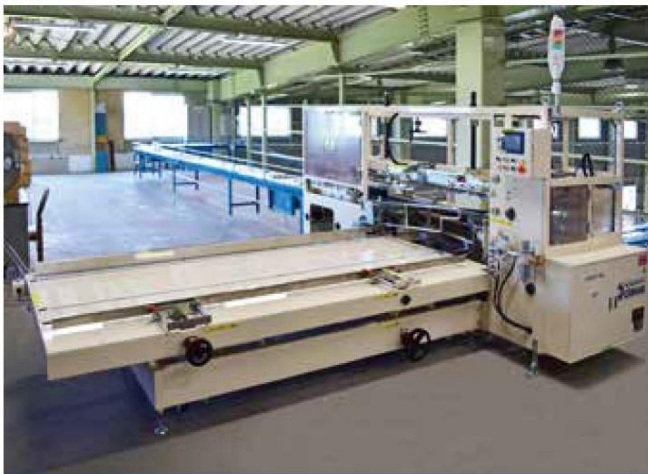
3 製函機 出荷用段ボールを自動組み立てし搬送部へ排出。
